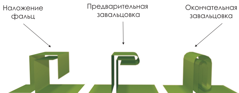
Рис.6 Завальцовка фальц фальцевой кровли
